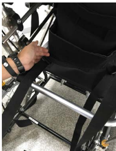
①スタビリティネット下側ベルトを背部のパイプに取り付けます。
